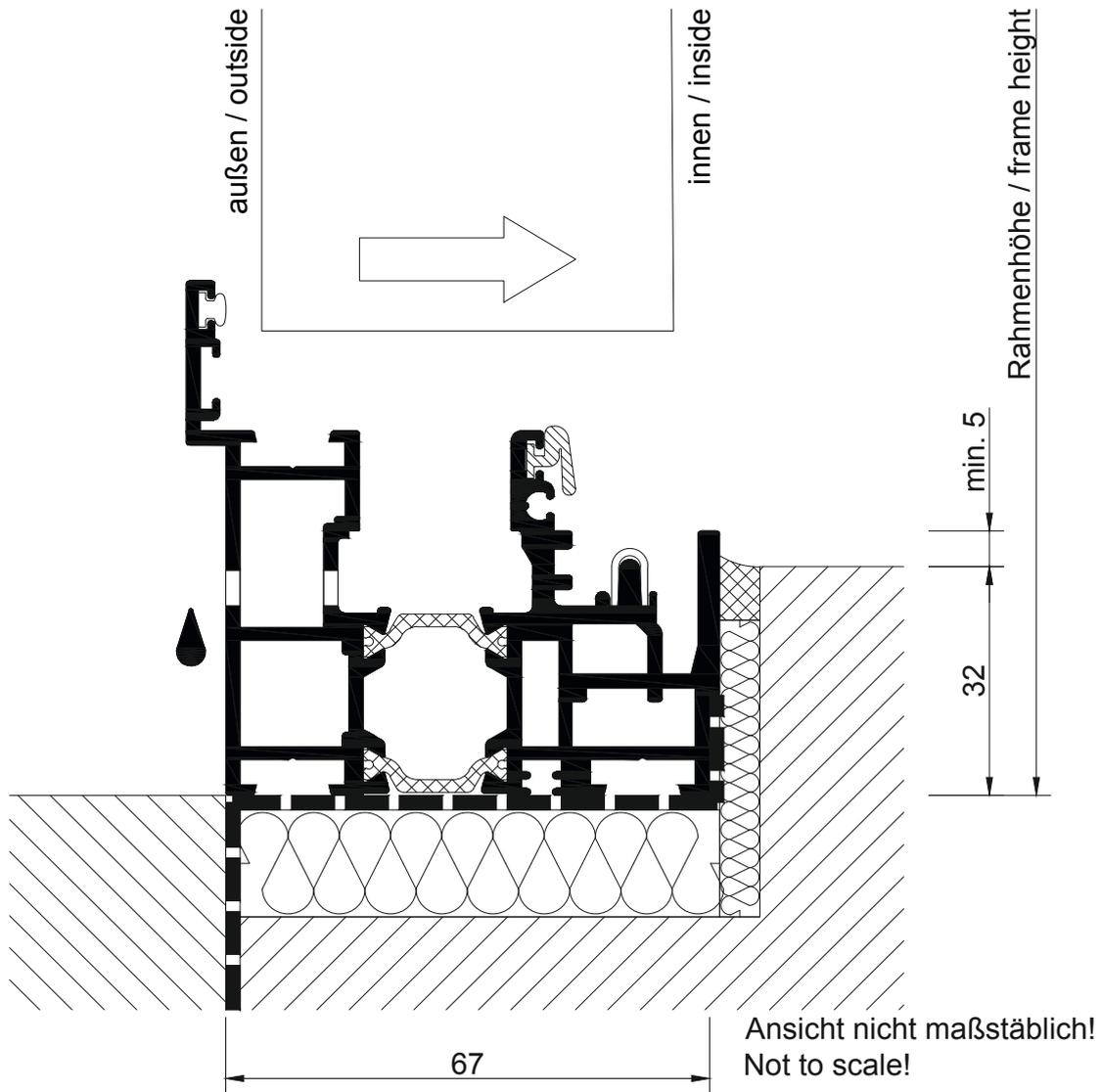
Bei den Bauanschlussbeispielen sind Abdichtungen, Befestigungen, Unterfütterungen für Trittfestigkeit usw. nicht detailliert dargestellt. | Please note the examples of junctions between the system and the structure of the building do not contain any details on seals, fixings, packers, etc.
