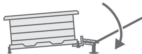
Den Multicube mit der Hebevorrichtung anheben. Dazu den Hebel in Pfeilrichtung nach unten drücken.
