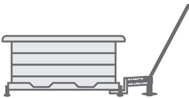
Die Hebevorrichtung unter den Multicube schieben.
